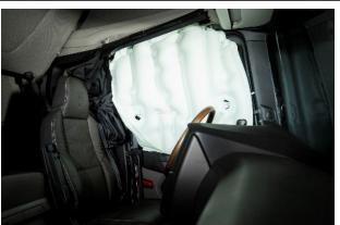
Die neue Scania Truck-Generation kann mit Seitenairbags ausgestattet werden, die über den Türen in den Dachhimmel integriert werden – eine einzigartige, für Trucks noch nie dagewesene Lösung.
