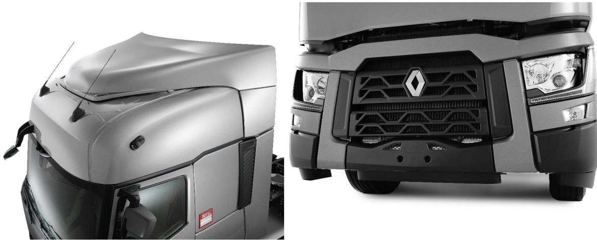
***Der T 2016 mit integriertem Spoiler unter dem Stossfänger. Ein neuartiger fester Dachspoiler mit niedrigem Gewicht und ohne Metallbeschlagteile verbessert den Luftwiderstand des Renault Trucks T 2016.***
